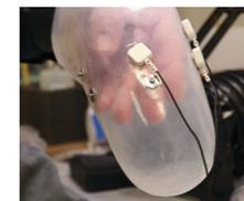
5. Stecken Sie die Elektrodenplatten auf die Elektrodenkappen-Pfosten und stellen Sie sicher, dass diese sicher befestigt sind. Die Positionen der Elektroden können später immer noch bei Bedarf geändert werden.
