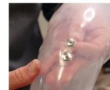
4. Verwenden Sie einen Kabelschneider, um den Pfosten zu kürzen. Der Pfosten sollte nicht über die Schnappmutter hinausragen, wenn diese an ihrem Platz gesichert ist.
