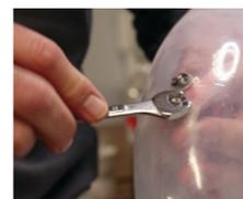
3. Bringen Sie die Schnappmutter am Pfosten der Elektrodenkappe an und ziehen Sie diese handfest an. Verwenden Sie den mitgelieferten Innensechskantschlüssel (CP-HXD) um diese bequem anzuziehen.
